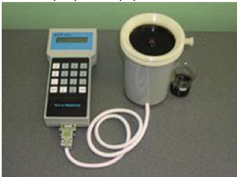
Рисунок 1. Анализатор ВАД-40М с выносными датчиком емкостью: 130 см 3
