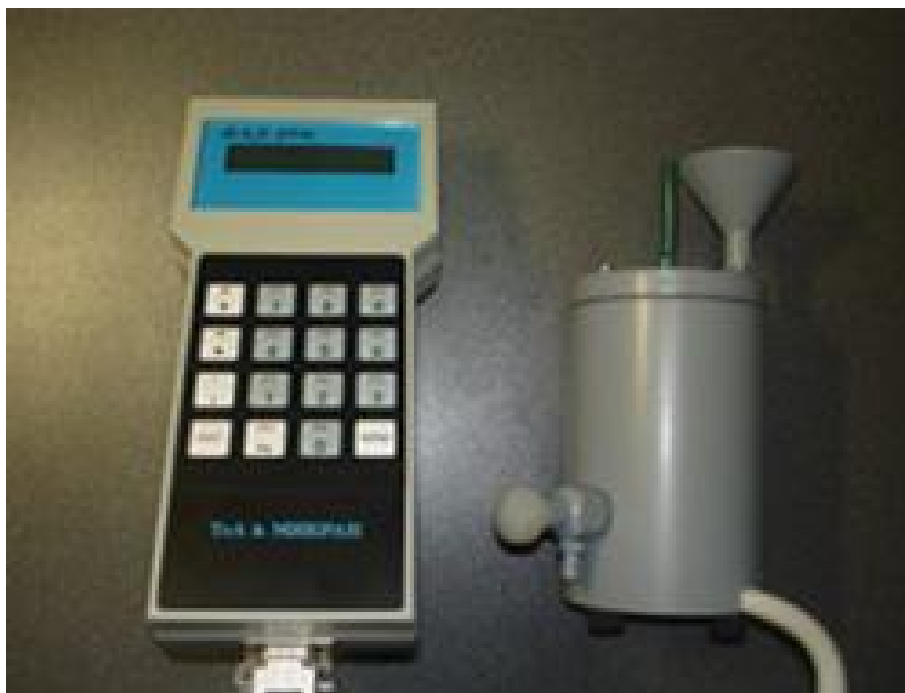
Рисунок 2. Анализатора ВАД-40М с выносными датчиком вместимостью 220 см 3
